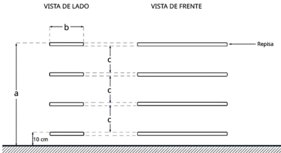
Ilustración 3 - Esquema de medidas de muebles de guardado
