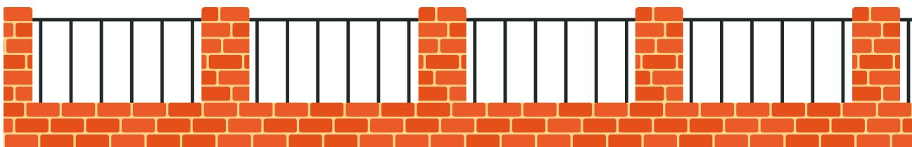
Se refuerza con castillos de concreto armado cada 3 metros y cadena de cimentación y dala en la parte superior. La cimentación, adaptada al tipo de suelo y condiciones climáticas o sísmicas, puede incluir zapatas aisladas, zapata corrida o cimiento de piedra, con características definidas por un especialista.
