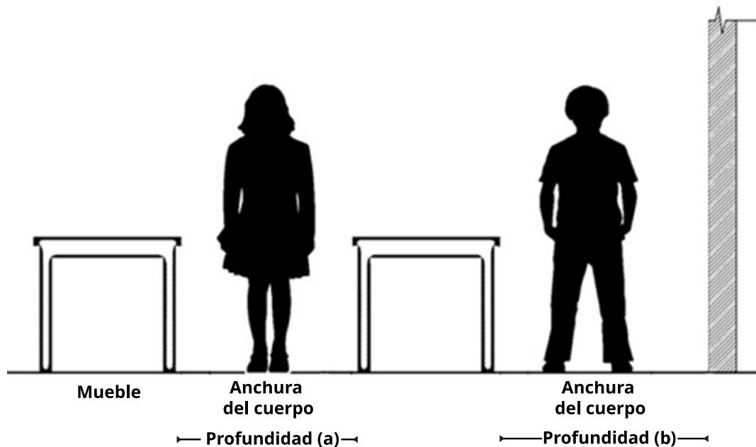
Ilustración 4 - Separaciones mínimas entre muebles y entre mueble y muro
